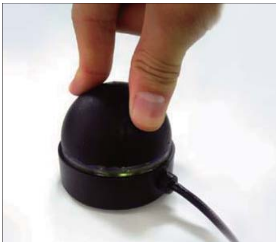
弾性体表面に加わった力の三次元ベクトル分布を検出する触覚センサです。
