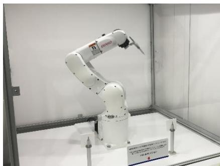
VS-060は、6軸垂直多関節ロボット4Kg可搬でクラストップレベルの高速性能を実現した産業用ロボットです。
