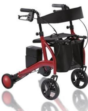
ハンドルには使用者が手をかけているかどうかを感知するためのセンサー、本体には使用者の動きに加えて道の傾斜、状態などの使用環境を感知するためのセンサーが取り付けられています。これらのセンサーで感知した情報をもとに、モーターを動かしリアルタイムで進む方向へのアシストとブレーキを自動的に切り替えながら、歩行を助けています。上り坂ではパワーアシストで推進力を加え、下り坂ではブレーキを適度に利かせ減速、また手を離したときには自動的に停止するなど、臨機応変に歩行をサポートします。おしゃべり機能もついており、「急斜面です。注意してください」などと声でもアシスト、終了時には歩行距離、さらには「お疲れ様でした」とサポートしてくれます。
