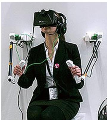
操縦者はヘッドマウントディスプレイを装着し、コックピットからロボットを操縦します。ロボットとコックピットはインターネットを介し、認証サーバーを経由した後、P2Pで接続します。ロボットは操縦者の頭や腕の動きをトレースし、ジョイスティックの操作により移動でき、内蔵されたカメラ・マイクからは現地の映像や音声が操縦者に送られ、会話とジェスチャーによるコミュニケーションがリアルタイムで可能となります。
