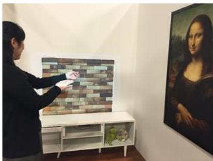
既存のプロジェクトマッピングが静止物の表面に動画を映写する技術であるのに対し、変幻灯は、静止物に動きのパターンだけをモノクロで投影することで、静止物そのものが動いているように見せる技術です。人の脳は対象の色・形・動きを別々に分析し、後から統合することで物が動くようすを知覚します。変幻灯で投影するのは動きの情報のみのため、静止画の色や形は動きませんが、脳にはこれらの情報同士に整合があっても、それを補正しようとする働きがあります。この現象を利用して、人の目にはまるで対象が動いているかのように錯覚させることができます。
