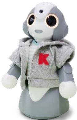
Kibiroは、人間の機微（心の微妙な変化）を理解するように独自開発された人工知能「KIBIT」を搭載した、「学んで答える、小さなロボット」です。
