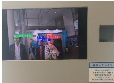
カメラに映った人の顔画像を分析し、その人の性別と年齢を推定します。主に顔の輪郭や眉毛・目・鼻・口角の距離などを分析し、これらの特徴から性別と年齢を総合的に推定します。1人の推定に要する時間は約0.04秒で、カメラに映った複数の人を同時に推定することもできます。
