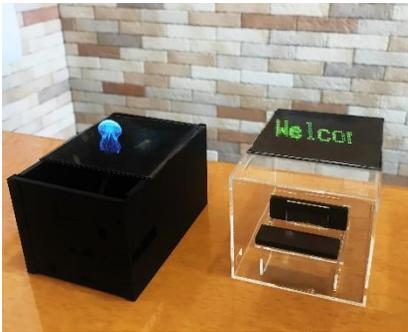
「パリティミラー®」は、空中映像を実現する最新のナノテクノロジーを駆使した特殊な光学素子です。微小マイクロミラーによって構成された2面コーナリフレクタ（2枚の鏡が直角に組み合わさったもの）を多数平面に並べた構造となっており、このミラーで物体の光を反射することで、空中に像を映し出しています。パリティミラー®による空中映像は、専用のコンテンツや特殊な画像処理を必要とせず、現実の物体の様な存在感・臨場感を味わうことができます。また、各種センサーと組み合わせて未来的なIoTインターフェースとしてさまざまな用途にも使うことが可能です。
