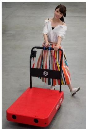
「CarriRo」は、搬送作業を、女性や年配の方でも楽しく快適に行えることを目指し開発されました。荷物の運搬に用いる台車にロボット技術を適用し、負荷を軽減するアシスト機能や、作業員についてくるカルガモ機能、指定したエリアを自動で移動する自律移動機能を搭載しています。連続稼働時間8時間、最高時速は6kmと、基本的な性能も高く、様々なシーンでの活用が想定されています。これらの機能により、作業員の負荷を軽減する他、運搬量の増加や運搬の自動化による生産性の向上が見込まれます。また、市街地に溶け込むデザインで、新しいワークスタイルを提案すると同時に、新しい労働力を取り込むことで人手不足の解消に貢献します。
