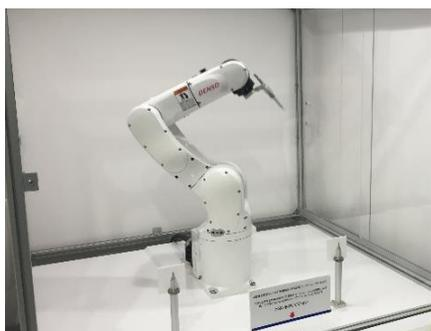
「VS-060」は、6軸垂直多関節ロボット4Kg可搬でクラストップレベルの高速性能を実現した産業用ロボットです。標準的な組立・搬送から、曲面をはじめ複雑な形状の製品の表面検査をしたり、磨いたり、ネジを締めたりといった作業を、熟練工のワザに匹敵する高度な技術で行うことができます。
