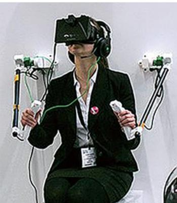
「caiba (カイバ)」は、インターネットを介して動作する遠隔操作ロボットです。操縦者はヘッドマウントディスプレイを装着し、コックピットからロボットを操縦します。ロボットとコックピットはインターネットを介し、認証サーバーを経由した後、P2Pで接続します。ロボットは操縦者の頭や腕の動きをトレースし、ジョイスティックの操作により移動でき、内蔵されたカメラ・マイクからは現地の映像や音声操縦者に送られ、会話とジェスチャーによるコミュニケーションがリアルタイムで可能となります。
