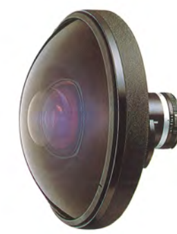
フィッシュアイ・レンズ (6mm/ニコン製) フィルム面に円形画像を作り、画角180度以上をもつ魚眼レンズ。被写界深度は事実上無限で、遠近感のデフォルメーションなど特殊な効果が得られることになった。
