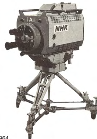
1964 210カラーテレビカメラ (NHK技術研究所開発) 輝度信号と色信号の2つの撮像管による分離輝度方式のカメラ。それまでの310方式にないカラー画質、鮮明白黒映像を実現。東京オリンピックの衛星中継でも活躍した。
