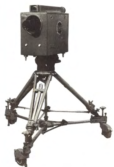
1950 第3号アイコノスコープカメラ (NHK技術研究所製) 従来型より小型化し、さらにファインダーなども改良。放送開始25周年記念放送をはじめ、全国巡回テレビ公開放送などに活躍した。
