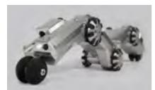
人が入れないような細い配管内を自由に移動するパイプ探査ロボット。配管内を移動しながら撮影した映像と、位置情報から作成した配管図面を組み合わせて、配管の状態を診断します。
